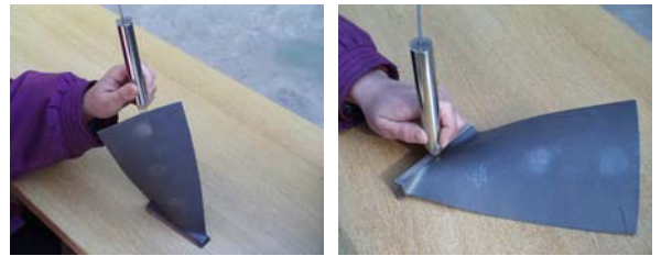
非常短小的裂纹也可以测量
